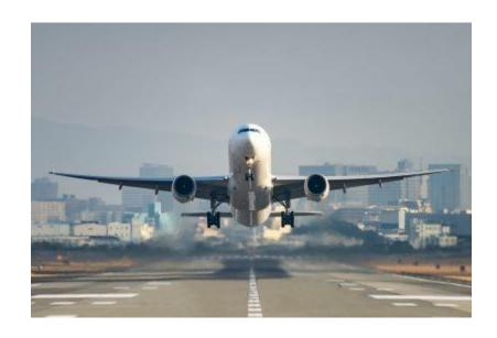
تستخدم قاعدة بيرنولي عند تصميم أجنحة الطائرات، حيث يصمم الجناح ليكون منحني عند سطحه العلوي وسطحه السفلي مستقيماً مما يجعل الهواء ينساب على السطح العلوي بسرعة أكبر من انسيابه على السطح السفلي للجناح، وبالتالي يكون ضغط الهواء أقل عند السطح العلوي بينما يزيد ضغط الهواء أسفل الجناح، ويؤدي ذلك إلى رفع الطائرة لأعلى.
